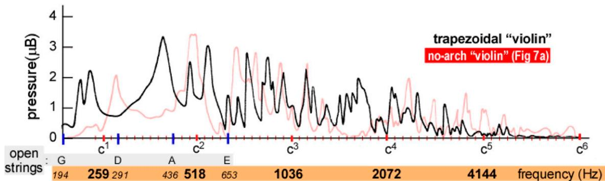
Abb. 8. Frequenzkurve einer trapezförmigen Geige M XVI
