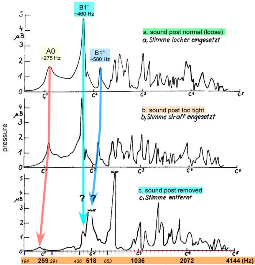
Abb. 5. Frequenzkurven der Geige M IX bei verschieden s eingesetzt und entfernter Stimme
